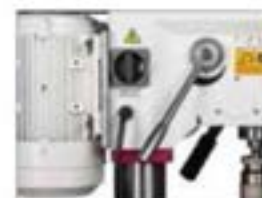
Leva per variazione rapida della velocità
