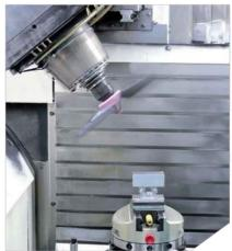
Le pale della Clean Tec si aprono automaticamente grazie alla velocità di rotazione del mandrino della macchina
