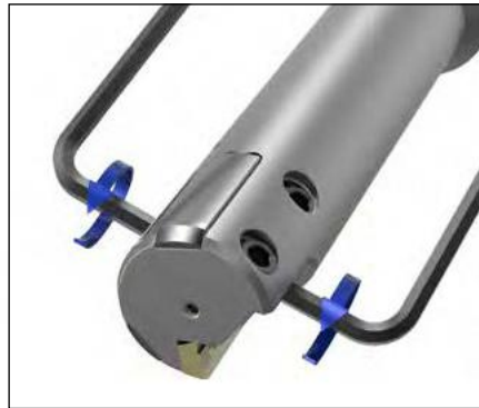
2. Allentare la staffa di serraggio: Ruotare il grano a doppio effetto su ambo i lati di 2-3 giri in senso antiorario (inserto rivolto verso il basso).
