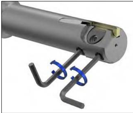
1. Ruotare i due grani filettati di \frac{1}{2} giro in senso antiorario.
