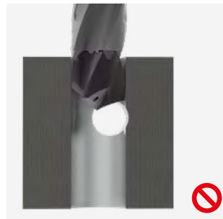
Foro fuori centro; Tagliante trasversale non ingranato
