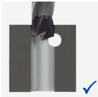
Foro fuori centro; Tagliante trasversale ingranato
