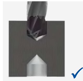
Sfondamento con controforo; v_f = -50\%
