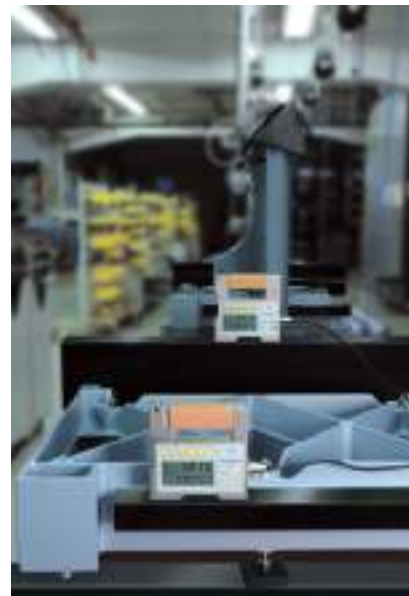
Quando 2 CLINOBEVEL 2 sono collegati, uno dei due strumenti diventa il riferimento.
