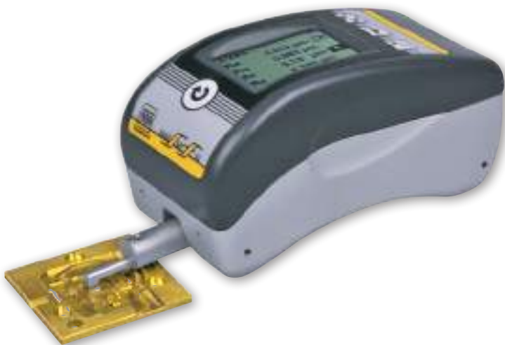
Misura di punti stretti e profondi grazie alla prolunga per tastatore da 100 mm
