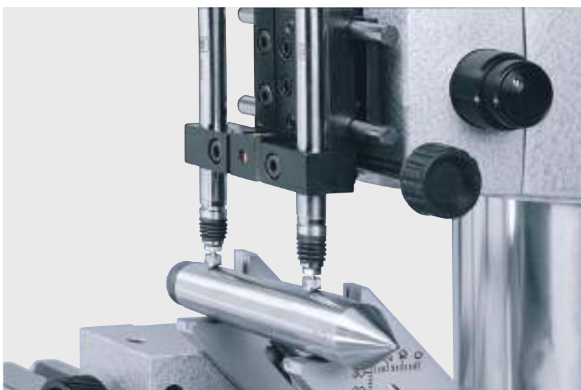
Misura del run-out di un cono con tastatori induttivi
