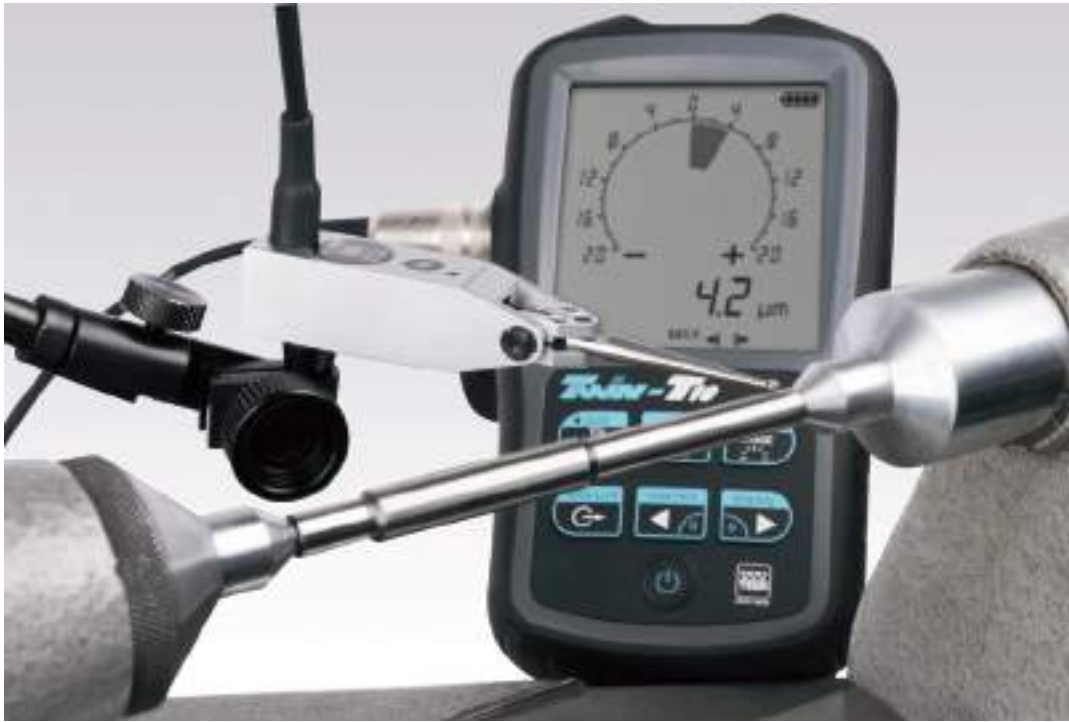
Misura di un run-out con il TWIN-T10 ed un tastatore a leva orientabile GT 31
